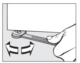
Compense los desniveles del suelo por medio de las cuatro patas roscadas. Este espacio de ventilación entre la parte inferior de la secadora y el suelo no puede reducirse mediante paneles de zócalos, moquetas de pelo largo, etc. De lo contrario, no queda garantizada una entrada de aire suficiente.
