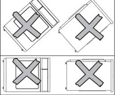
Si el transporte no se realizase tal y como se ha descrito, es necesario un tiempo de parada de 1 hora, antes de realizar la conexión eléctrica de la secadora. ¡De lo contrario, las bombas caloríficas podrían sufrir daños!
