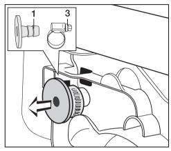
Retire los accesorios de la parte posterior inferior de la secadora: Adaptador (boquilla) 1 y la abrazadera para mangueras situada detrás 3.
