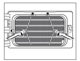
Coloque el mango con el filtro delante de ambos pasadores guía.
