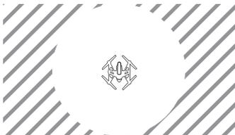
Paso 1) No calibrar la brújula dentro de un aparcamiento, cerca de edificios o estructuras metálicas. Para un mejor calibrado, realizarlo sólo en campo abierto, lejos de tendidos eléctricos y otras estructuras metálicas o de hormigón.
