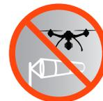
¡NO VUELE CON VIENTOS QUE SUPEREN LOS 13-19 KM/H (8-12 MILLAS POR HORA)!
