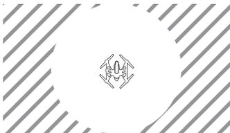
**Étape 1)** Ne calibrez pas la boussole dans un parking fermé, près de bâtiments ou de surfaces qui contiennent du métal (par ex. armatures de parking en métal). Ne calibrez la boussole qu'en plein air, loin des lignes à haute tension et autres surfaces/structures en métal ou béton.
