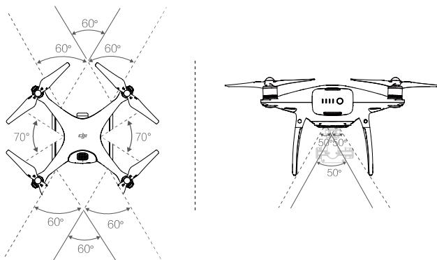
**⚠ 在 P 模式下，当飞行速度小于 6 m/s 时，前后视觉系统均有效；而当飞行速度大于 6 m/s 时，仅朝向飞行器前进方向的视觉系统工作，请谨慎飞行。**
