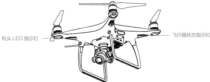
机头 LED 指示灯用于指示飞行器的机头方向，飞行器启动后将会显示红灯常亮。尾部的飞行器状态指示灯指示当前飞控系统的状态。请参考下表了解不同的闪灯方式所表示的飞控系统状态。
