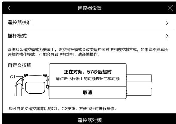
4. 使用合适工具按下对频按键（如下图所示）后松开，等待几秒钟后完成对频。对频成功后，遥控器指示灯显示绿灯常亮。
