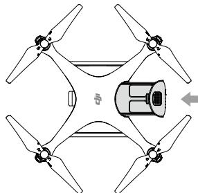
**⚠** • 如果电池没有卡紧，有可能导致电源接触不良，可能会影响飞行的安全性，甚至无法起飞。
