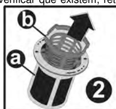
Puxe e separe o filtro de plástico e metal. **3** Depois, separe o filtro de partículas maiores do filtro de partículas menores. **2** Limpe-os com muita água, deixe-os estar um tempo debaixo da torneira. Volte a colocar o filtro de plástico e metal. Coloque depois o filtro de partículas maiores de tal forma que as marcas estejam alinhadas. Depois coloque o filtro de partículas menores no filtro de plástico e metal e rode-o na direcção da seta e ficará fechado. **4**
