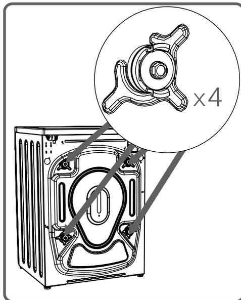
Por esta razón, los tornillos de seguridad para transporte deben ser aflojados mediante rotarlos en sentido antihorario con una llave apropiada.
