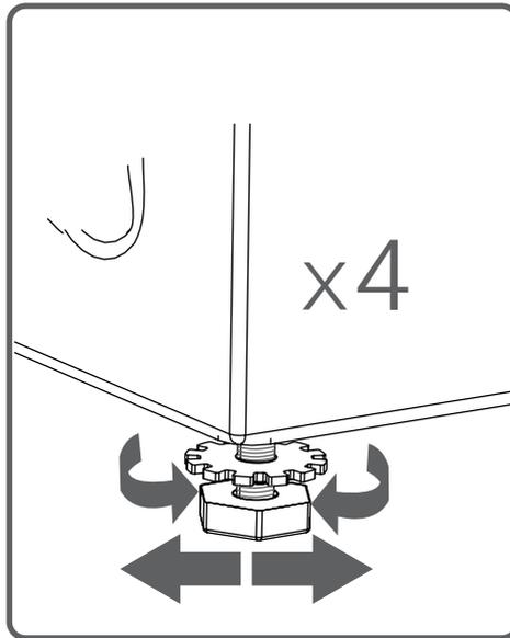
• Nunca coloque cartón, madera o materiales parecidos bajo su máquina con la intención de estabilizar las distorsiones en el suelo.
