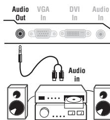
For å koble til et stereoanlegg bruker du audiokabel. Kabelen skal gå mellom **Audio out**-utgangene på TV-apparatet og inngangen "AUDIO IN" "L" og "R" på stereoanlegget.
