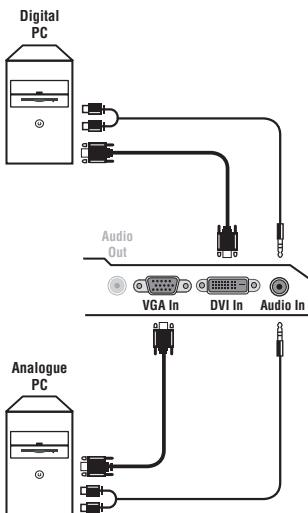
Koppla bildskärmsutgången på din dator till ingången **PC VGA In** eller **DVI In** (finns endast på vissa modeller) på TV-apparaten.
