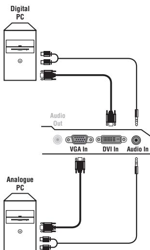
Koble datamaskinenes skjerm til inntaket **PC VGA In** eller **DVI In** (Kun tilgjengelig på enkelte modeller) på TV-apparatet. Koble datamaskinenes lyduttak **Audio out L** og **R** til inntaket **Audio in (PC)** på TV-apparatet.
