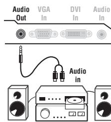
Brug et audiokabel for at tilslutte fjernsynet til et Hi-Fi-anlæg.
