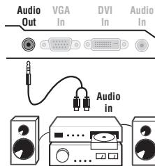
Per il collegamento ad un sistema hi-fi, utilizzare un cordone di collegamento audio e collegare l'uscita audio **Audio out**” del televisore agli ingressi “**AUDIO IN**” “L” e “R” del vostro amplificatore hi-fi.
