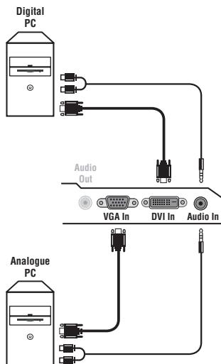
Slut computerens skærmudgang til indgangen **PC VGA In** eller **DVI In** (kun på bestemte modeller) på fjernsynet. Slut lydudgangen **Audio out L** og **R** på computeren til indgangen **Audio in (PC)** på fjernsynet.
