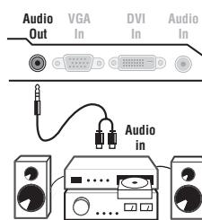
Om een hi-fi systeem aan te sluiten, dient u een audiokabel te gebruiken en de **Audio out** uitgangen van het TV toestel aan te sluiten op de ingangen "AUDIO IN" "L" en "R" van de versterker van uw hi-fi.
