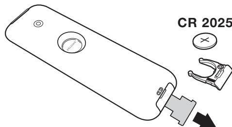
Trekk ut isolasjonsarket fra batteriet for å aktivere fjernkontrollen.
