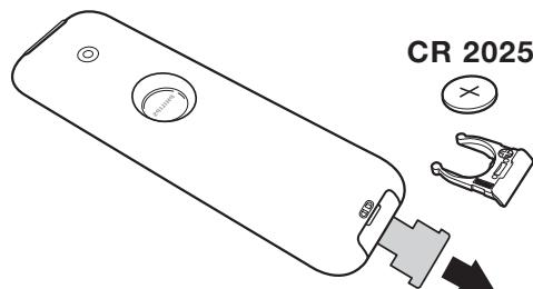
Fjern isoleringsstrimlen fra batteriet for at aktivere fjernbetjeningen.
