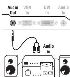
Pour le raccordement à une chaîne Hi-fi, utilisez un cordon de liaison audio et connectez la sortie son **Audio out** du téléviseur à une entrée "AUDIO IN" "L" et "R" de la chaîne Hi-fi.
