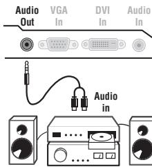
Om TV-apparaten skall anslutas till en hifi-anläggning används en ljudkabel. Anslut ljuduttaget **Audio out** på TV-apparaten till « **AUDIO IN** » « **L** » och « **R** » på hifi-anläggningen.
