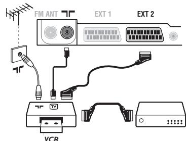
Eseguire i collegamenti necessari. Utilizzare un cordone di collegamento (presa scart) di tipo europeo di buona qualità.
