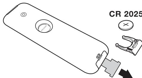
Ziehen Sie die Isolationsfolie von der Batterie ab, um die Fernbedienung zu aktivieren.
