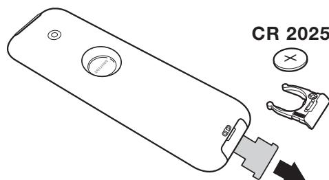
Dra bort den isolerande lappen från fjärrkontrollens batterilucka för att aktivera fjärrkontrollen.
