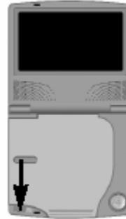
2. Abra la cubierta protectora. La cubierta se abre hasta un ángulo máximo de 135° ; no intente abrirla más.
