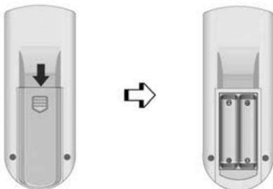
**1** Zum Öffnen schieben Sie die Abdeckung in Pfeilrichtung.
