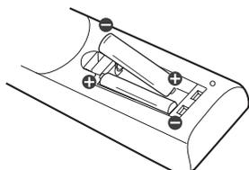
Stellen Sie sicher, dass die Anzeigen + und – auf den Batterien zu den Anzeigen im Batteriefach passen.
