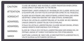
Esta etiqueta está localizada na caixa de protecção do raio laser localizada no interior do aparelho.
