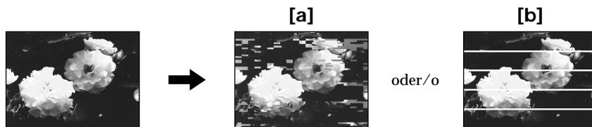
Reinigen Sie im Falle der obigen Symptome und bei den Bildstörungen **[a]** oder **[b]** die Videoköpfe mit der Sony Reinigungscassette V8-25CLD (nicht mitgeliefert). Wenn das Problem nach der Reinigung nicht behoben ist, wiederholen Sie den Reinigungsvorgang.
