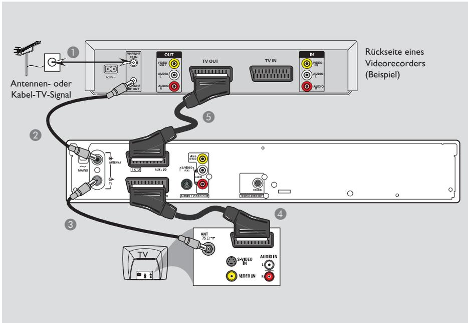
Rückseite eines Videorecorders (Beispiel)
