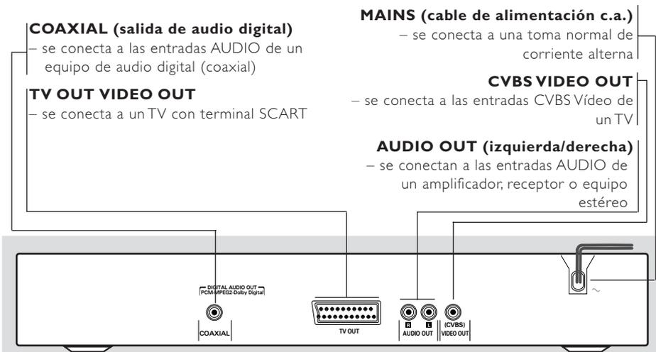
**Precaución:** No toque los contactos internos de los conectores del panel posterior. Una descarga electrostática podría ocasionar daños irreparables en la unidad.
