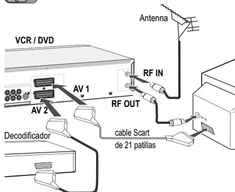
**Conexión de un decodificador** Un decodificador es un aparato para decodificar emisiones de TV (p. ej. emisoras de TV de pago). Conecte el decodificador con un cabo Scart de 21 patillas (no suministrado) al AV2 aparato.
