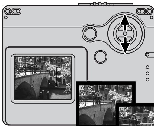
En la posición de teleobjetivo máxima, presione la tecla de arriba del controlador para activar el zoom digital. La ampliación del zoom aparecerá en la esquina superior derecha del monitor.
