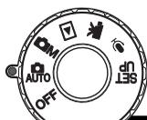
Portate il commutatore di impostazione sulla posizione di registrazione e accendete la fotocamera; si attiva lo schermo LCD. La registrazione automatica utilizza due sofisticati sistemi di autofocus: l'area AF e l'AF con soggetti in movimento per inquadrare e seguire il soggetto nei riquadri di messa a fuoco sovradimensionati.
