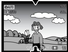
L'AF con soggetti in movimento si modifica in AF a scatto singolo in situazioni di scarsa luminosità. L'AF a scatto singolo viene usato con l'autoscatto e il comando a distanza (p. 38), con lo zoom digitale o se lo schermo LCD è spento (p. 31).
