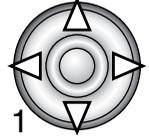
Presionando el botón central del controlador (2) el punto de enfoque vuelve al centro del área de la imagen. Para regresar al área de enfoque amplia presione y mantenga el botón hasta que aparezcan las líneas del marco del área de enfoque amplia.
