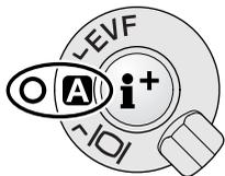
**Visualización automática** - la cámara cambiará automáticamente entre mostrar la imagen en el EVF o en el monitor LCD. Los sensores visuales del EVF monitorizan si el EVF se utiliza y cambia la situación del visor según necesite.
