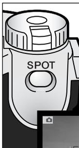
El botón del bloqueo del AE puntual, situado debajo del sintonizador principal en la parte trasera del cuerpo de la cámara, bloquea el sistema de exposición automático. Esta función permite fijar la exposición en relación a un elemento específico dentro de la escena, o bien mediante una cartulina gris fuera de la escena.
