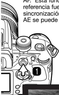
Enmarque el elemento de referencia de la exposición en el visor, dependiendo del modo de medición empleado (p. 50). Presione y mantenga el botón de bloqueo del AE (1) para bloquear la exposición; aparecen la velocidad de obturador y la apertura, y el indicador del AEL se muestra en el visor y en el monitor. Suelte el botón para cancelar el bloqueo.
