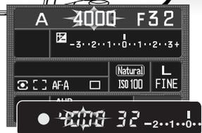
Presionando el disparador hasta la mitad se visualizará la correspondiente velocidad de obturador. Con la sensibilidad de la cámara (ISO) fijada en automático, la velocidad del obturador puede no llegar a cambiarse cuando se ajusta la apertura, debido a que las velocidades de obturador se pueden cambiar en pasos más precisos. Presione el disparador hasta el final para sacar la fotografía.
