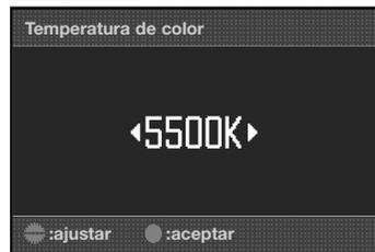
El sintonizador de control delantero ó las teclas de izquierda / derecha del controlador ajustan la temperatura de color en miles de grados. El sintonizador de control trasero ó las teclas de arriba / abajo del controlador ajustan la temperatura de color en cientos de grados.
