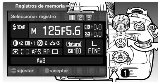
Para guardar las configuraciones actuales de la cámara, presione el botón "M SET" (1); la configuración aparece en la pantalla de registros.
