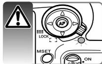
Nunca desconecte la cámara cuando la luz de acceso esté encendida - los datos o la tarjeta de memoria podrían dañarse de forma permanente.
