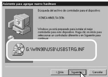
El “Asistente para agregar nuevo hardware” confirmará la ubicación del controlador. Podrá localizar uno de tres controladores: MNLVENUM.inf, USBPDR.inf, o USBSTRG.inf. La letra que designa la unidad para el CD-ROM puede variar dependiendo del ordenador. Haga click en “Siguiente” para instalar el controlador en el sistema.
