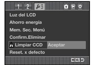
Antes de exponer el CCD, aparece una pantalla de confirmación. Escogiendo "Si" se ejecuta la apertura del obturador y el espejo; con el "No" se cancela la operación de limpieza.
