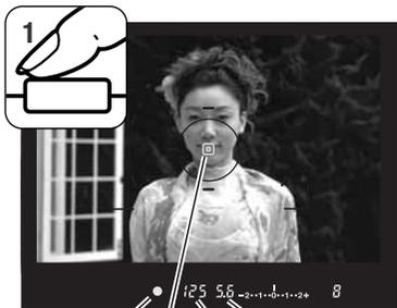
Presione el disparador hasta la mitad para activar los sistemas de enfoque automático y de exposición automática (1). La señal de enfoque del visor (A) confirma el enfoque y el área puntual o de AF local (B) se ilumina brevemente para indicar el punto de enfoque. Si la señal de enfoque parpadea, repita el procedimiento.
