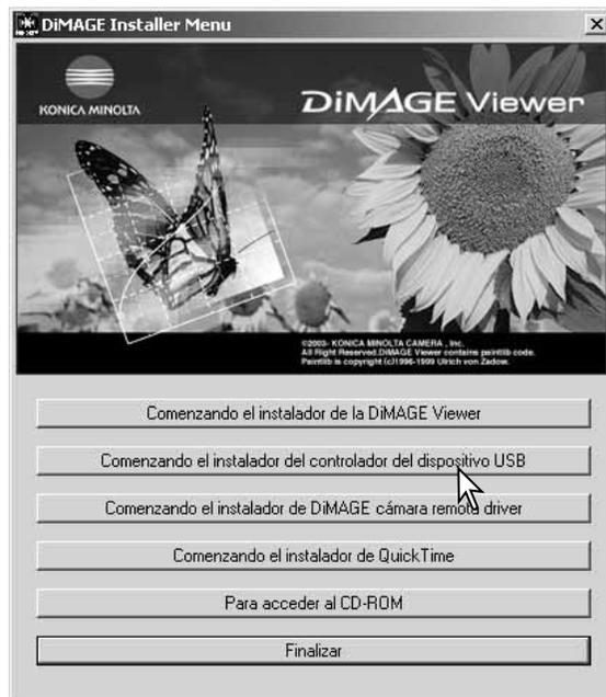
Antes de conectar la cámara al ordenador, introduzca el CD-ROM del DiMAGE Viewer en su unidad. Se activará automáticamente el menú de instalación de DiMAGE. Para instalar automáticamente el controlador USB de Windows 98, haga click en el botón de “Comenzando el instalador del controlador del dispositivo USB”. Aparecerá una ventana para confirmar que debe instalar el controlador; haga click en “Si” para continuar.
