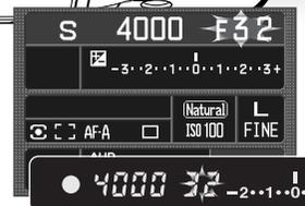
Presionando el disparador hasta la mitad se visualizará la apertura correspondiente. Presione el disparador hasta el final para sacar la fotografía.
