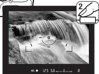
Mientras mantiene presionado el botón del AEL, coloque el objeto en el marco de enfoque y presione el disparador hasta el final para sacar la fotografía. Presione el disparador hasta el final para sacar la fotografía.
