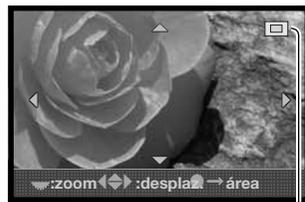
Las cuatro teclas de dirección del controlador desplazan la zona ampliada. El localizador (2) indica la porción de la imagen visualizada. El sintonizador de control trasero cambia la ampliación.
