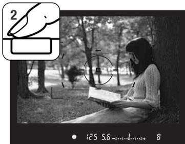
Sin levantar el dedo del disparador, recomponga el objeto dentro del visor. Presione el disparador hasta abajo para sacar la fotografía.
