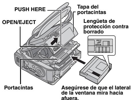
**1** Deslice y mantenga presionado **OPEN/EJECT** en la dirección de la flecha, y a continuación abra la tapa del portacintas hasta que se abra completamente. El portacintas se abre automáticamente.
