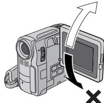
El monitor LCD no se puede girar hacia abajo (en la dirección X) desde la posición mostrada arriba. Si se gira en la dirección equivocada, se puede provocar el mal funcionamiento del aparato.
