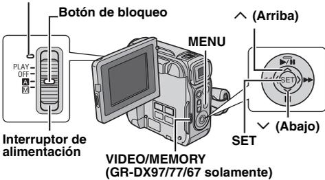
Seleccione el modo de funcionamiento adecuado según sus preferencias, mediante el interruptor de alimentación y el interruptor **VIDEO/MEMORY**. (GR-DX97/77/67 solamente)
