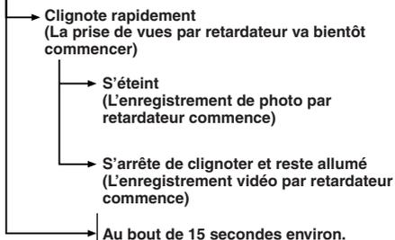
**5** Pour engager le retardateur pour l'enregistrement vidéo, appuyer sur la touche de marche/arrêt d'enregistrement **11**. Au bout de 15 secondes, une tonalité retentit et l'enregistrement vidéo commence. Pour arrêter l'enregistrement par minuterie, appuyer de nouveau sur la touche de marche/arrêt d'enregistrement **11**. Le camescope revient en mode d'attente d'enregistrement.
