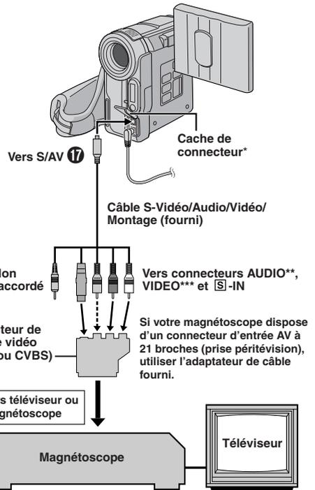
\* Pour raccorder les câbles, ouvrir ce cache.
