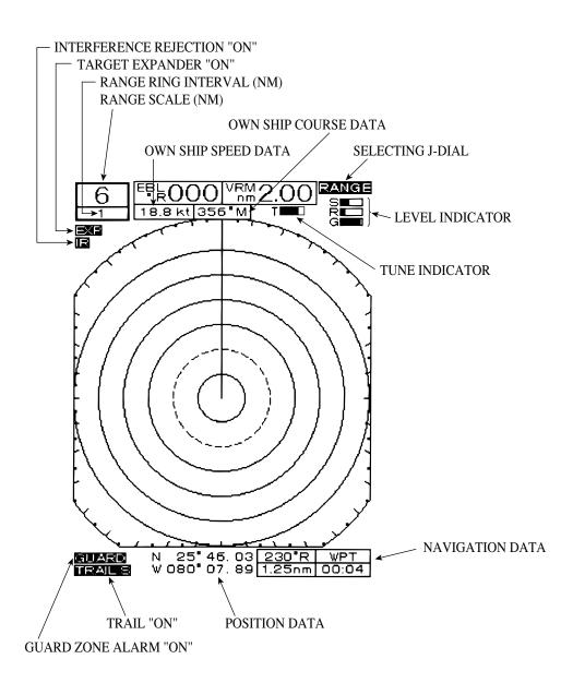
FIG. 4-3 LAYOUT OF THE SCREEN
