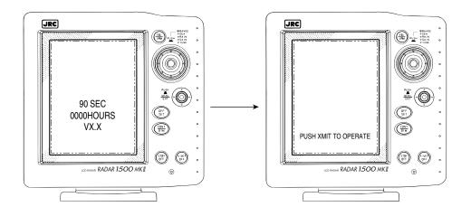
FIG. 4-2 TURNING THE RADAR ON/OFF
