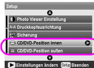
3. Stellen Sie den entsprechenden Wert ein. Sie können den Innendurchmesser zwischen 18 und 46 mm und den Außendurchmesser zwischen 114 und 120 mm jeweils in Schritten von 1 mm einstellen.
