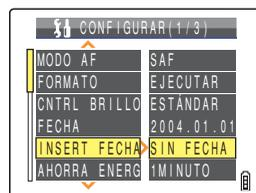
**3 Mueva la palanca de selección hacia arriba o hacia abajo para seleccionar [SIN FECHA] o [CON FECHA] y a continuación pulse .**
