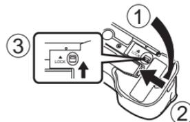
Asegúrese de usar pilas **alcalinas**, de **litio** o de **Ni-MH**. No utilice pilas de manganeso (vea las precauciones en la página siguiente).
