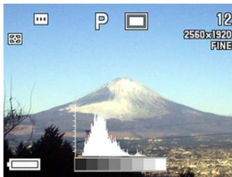
L'istogramma è un grafico dei livelli di luminosità dei pixel in termini di numero di pixel. L'asse verticale rappresenta il numero di pixel, mentre l'asse orizzontale rappresenta la luminosità. È possibile usare le informazioni sull'istogramma quando si registra, si corregge o si modifica un'immagine per determinare se i dettagli dell'immagine includano sufficienti ombre (lato sinistro), mezzi toni (centro) o zone di massima luce (lato destro).
