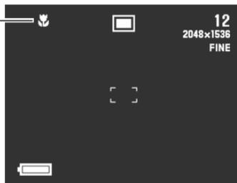
Bei jedem Drücken der
