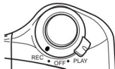
REC : Die Stromversorgung ist eingeschaltet und der REC-Modus (Aufnahmemodus) ist gewählt.
