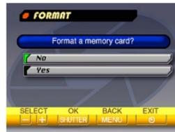
2. Utilisez [+] et [-] pour sélectionner "Yes", puis appuyez sur le déclencheur.
