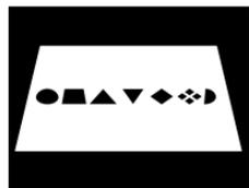
Prima della correzione della distorsione trapezoidale
