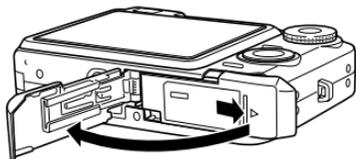
2. Tirando il fermo nella direzione indicata dalla freccia nell'illustrazione, allineare il segno della freccia sulla pila con il segno della freccia sulla fotocamera, e inserire la pila nella fotocamera.
