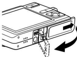
2. Ubique la tarjeta de memoria de modo que su parte trasera se oriente en la misma dirección que la pantalla de monitor de la cámara, deslícela cuidadosamente dentro de la ranura de tarjeta. Deslice la tarjeta hasta el fondo hasta que encaje en su lugar con un chasquido.
