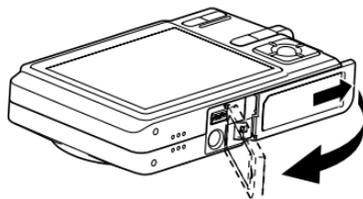
2. Mientras tira del tope en la dirección indicada por la flecha en la ilustración, alinee la marca de flecha sobre la pila con la marca de flecha sobre la cámara, y deslice la pila dentro de la cámara.
