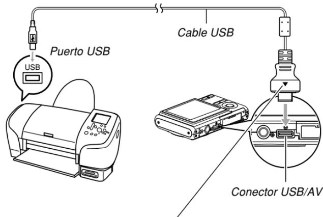
*Asegúrese de que el lado del conector marcado con una flecha (▲) esté orientado en la misma dirección que la parte delantera (lado del objetivo) de la cámara.*
