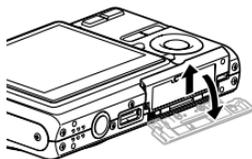
2. Ubique la tarjeta de memoria de modo que su parte delantera se oriente en la misma dirección que la pantalla de monitor de la cámara, deslícela cuidadosamente dentro de la ranura de tarjeta. Deslice la tarjeta hasta el fondo hasta que encaje en su lugar con un chasquido.
