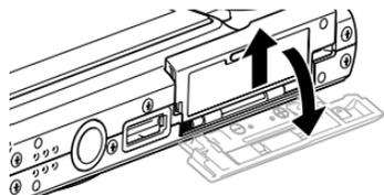
2. Con el logotipo EXILIM de la pila dirigido hacia arriba (en la dirección de la pantalla del monitor), sostenga el tope en la dirección indicada por la flecha mientras desliza la pila dentro de la cámara.
