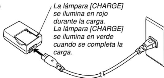
La lámpara [CHARGE] se ilumina en rojo durante la carga.
