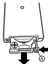
2. Passare le superfici della pila con un panno morbido e asciutto, e quindi collocare la pila sul portapila in modo che il suo lato positivo (+) sia rivolto verso l'alto (in modo che sia visibile).
