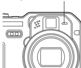
\* Le spie lampeggiano in tre modi. Il modo 1 consiste nel lampeggiamento una volta al secondo, il modo 2 consiste nel lampeggiamento due volte al secondo e il modo 3 consiste nel lampeggiamento quattro volte al secondo. La tabella riportata di seguito spiega cosa significa ciascun modo di lampeggiamento.
