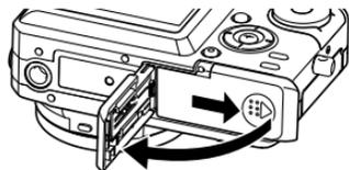
2. Tirando il fermo nella direzione indicata dalla freccia nell'illustrazione, allineare il segno (-) sulla pila con il segno (-) sulla fotocamera, e inserire la pila nella fotocamera.
