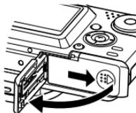
2. Posizionando la scheda di memoria in modo che il suo davanti sia rivolto nella stessa direzione dello schermo monitor della fotocamera, inserire con attenzione la scheda nell'apposita fessura.
