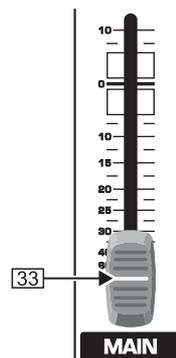
Fig. 2.13 : Fader de la sortie générale Main Out
