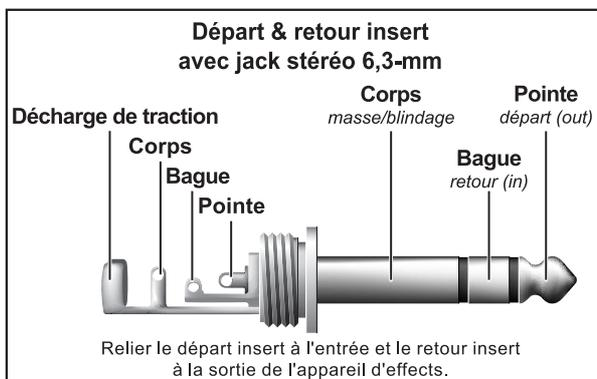
Relier le départ insert à l'entrée et le retour insert à la sortie de l'appareil d'effets.
