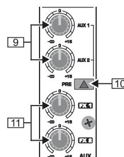
Fig. 2.3 : Commandes de départ AUX/FX des canaux
