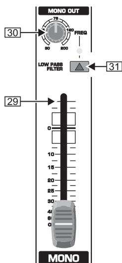
Fig. 2.11 : Fader Mono Out et filtre passe-bas
