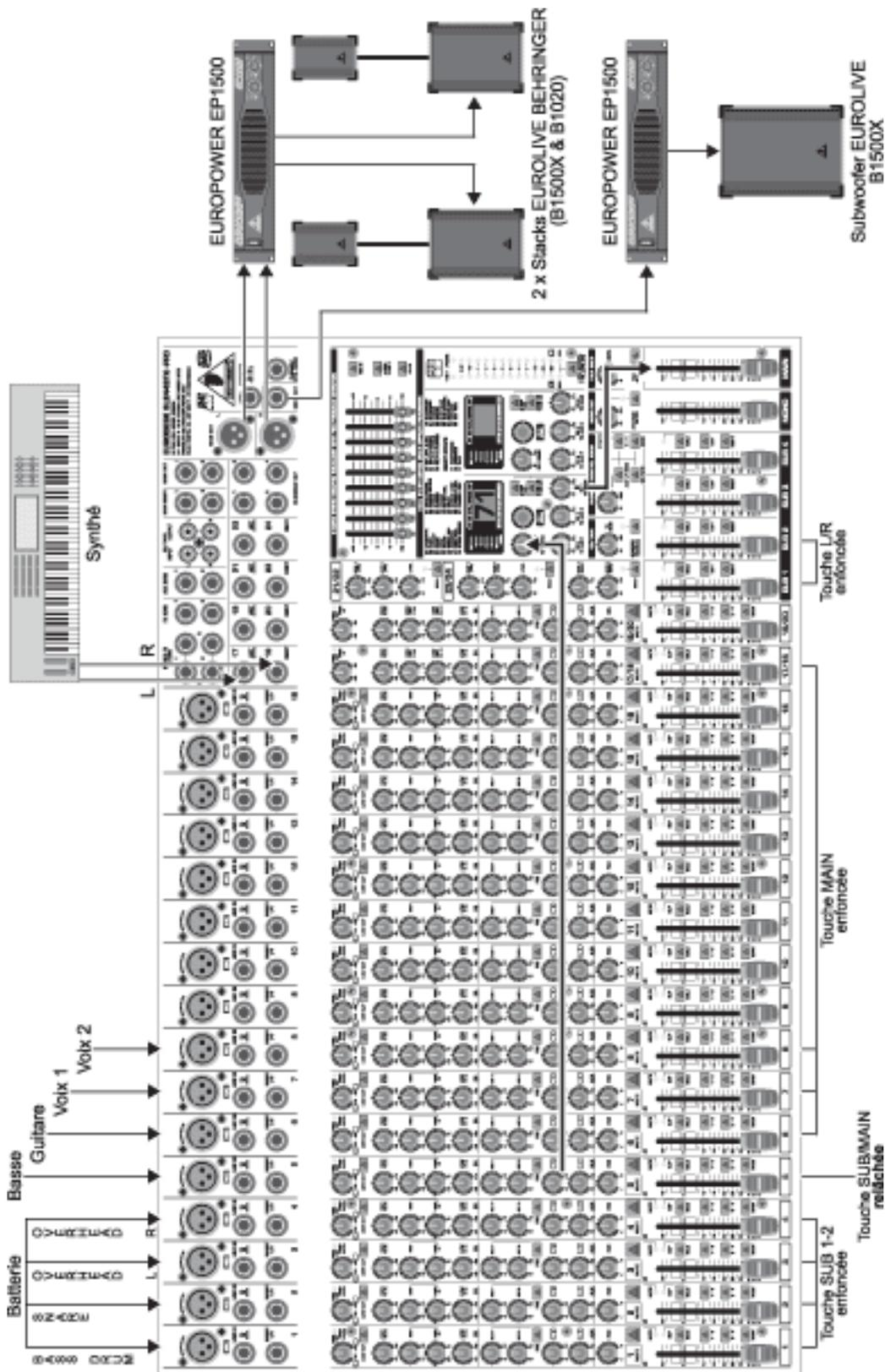
Fig. 4.2 : Câblage de la console en live
