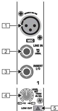
Fig. 2.1 : Connexions et commandes des entrées micro/ligne
