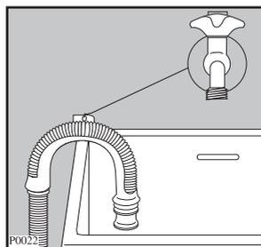
3. Sitúe la boca del tubo de descarga en el lavabo o pila con la ayuda de la pieza curva que se suministra aparte. La pieza curva se monta en la boca del tubo para facilitar su apoyo. Dicha pieza permite, mediante un orificio en su parte superior sujetarla a la pared para que el tubo no se desplace y evitar así posibles caídas de éste.
