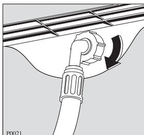
2. Si es necesario, oriente correctamente el tubo aflojando la tuerca del respaldo de la máquina. Después apriete la tuerca de nuevo para evitar pérdidas. Abra el grifo y compruebe que no existen fugas. Después ciérrelo de nuevo.
