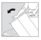
Deite a máquina de lavar, sobre a parte de trás, e coloque entre a máquina e o chão, um dos angulares de polistireno.
