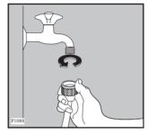
A) Comece a enroscar a mangueira na torneira, com cuidado para não danificar a rosca. Aperte bem a porca para evitar fugas de água.
