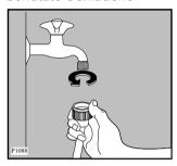
Das Schlauchende an der Maschinenrückwand kann in allen Richtungen gedreht werden.
