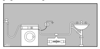
Der Verlängerungsschlauch darf keine Knie aufweisen.
