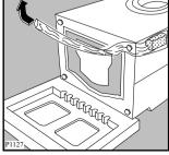
Stellen Sie die Maschine wieder gerade auf und schrauben Sie die restliche Schraube an der Rückwand aus. Ziehen Sie den Plastikzapfen heraus. 8. Verschließen Sie nun alle Öffnungen mit den Kunststoffabdeckungen, die sich im Beipack befinden.
