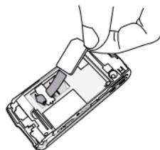
3. Deslice la batería en su ranura, con los conectores metálicos hacia abajo, hasta que haga tope. A continuación, fíjela empujando hacia abajo.
