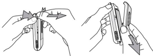
2. Retire la tarjeta SIM de su soporte e insértela en la ranura correspondiente, debajo del soporte metálico de fijación, hasta que haga tope.
