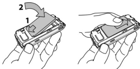
4. Coloque de nuevo la tapa trasera de su teléfono: enganche la parte delantera de la tapa a las pestañas de la parte superior del teléfono y, a continuación, ciérrela presionando la parte inferior hacia abajo.
