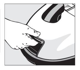
Desbloquear el filtro de aire, jalarlo hacia arriba de forma inclinada y extraerlo hacia adelante.
