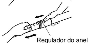
3. Introduza a extremidade da mangueira no aspirador carregando no botão de fixação da mangueira até encaixar. (para retirar, carregue no botão de fixação da mangueira e puxe-a para fora.)
