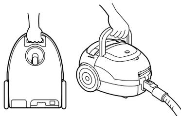
12. Quando não estiver a utilizar o aspirador, encaixe o suporte para o tubo no orifício respectivo com o aspirador na vertical. (fig. 1). Também pode guardar o tubo na horizontal. Empurre o suporte da escova para dentro da ranhura do suporte localizada na parte de trás do aspirador. (fig. 2)
