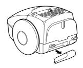
Quando não estiver em utilização, fixe o cabo do bocal ao orificio do corpo enquanto o aspirador está na posição vertical.
