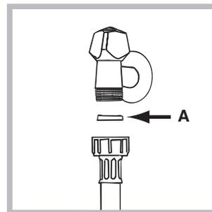
1. Introduzca la junta A en el extremo del tubo de alimentación y enrósquelo a un grifo de agua fría con boca roscada de 3/4 gas (véase la figura). Antes de conectarlo, haga correr el agua hasta que salga limpia.
