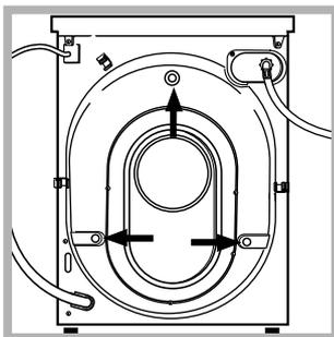
3. Enlevez les 3 vis de protection pour le transport, le caoutchouc et la cale, placés dans la partie arrière (voir figure).
