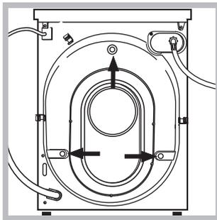
3. Távolítsa el a hátoldalon található, a szállításhoz felszerelt 3 védőcsavart, valamint a gumit a hozzá tartozó távtartóval (lásd ábra).
