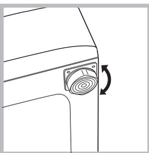
2. Si el piso no está perfectamente horizontal, compense las irregularidades desenroscando o enroscando los pies delanteros (véase la figura); el ángulo de inclinación medido sobre la superficie de trabajo, no debe superar los 2°.
