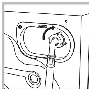
2. Συνδέστε το σωλήνα τροφοδοσίας στο πλυντήριο βιδώνοντάς το στην αντίστοιχη είσοδο νερού, στο πίσω μέρος επάνω δεξιά (βλέπε εικόνα).
