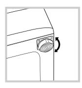
2. Se il pavimento non fosse perfettamente orizzontale, compensare le irregolarità svitando o avvitando i piedini anteriori (vedi figura); l'angolo di inclinazione, misurato sul piano di lavoro, non deve superare i 2°.
