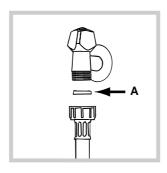
1. Inserire la guarnizione A nell'estremità del tubo di alimentazione e avvitarlo a un rubinetto d'acqua fredda con bocca filettata da 3/4 gas (vedi figura). Prima di allacciare, far scorrere l'acqua finché non sia limpida.
