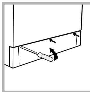
1. rimuovere il pannello di copertura sul lato anteriore della lavabiancheria con l'aiuto di un giravite (vedi figura);
