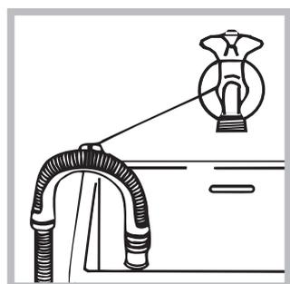
oppure appoggiarlo al bordo di un lavandino o di una vasca, legando la guida in dotazione al rubinetto (vedi figura). L'estremità libera del tubo di scarico non deve rimanere immersa nell'acqua.
