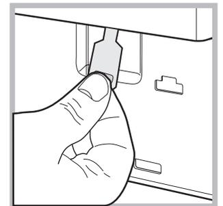
4. jeziček potegnite navzven, kakor prikazuje slika, da se sprostijo plastični zatiči; nato ga potisnite navzdol in odprite vratca.
