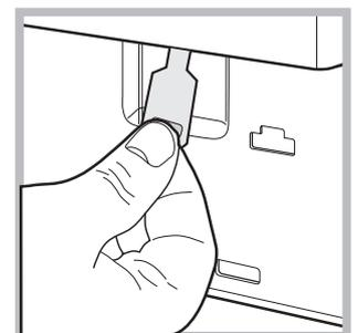
4. povucite prema vani jezičak prikazan na slici, sve dok ne otkočite plastični remen, kojeg zatim treba povući prema dole otvarajući istovremeno vrata;
