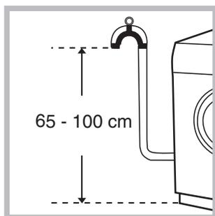
Odtočno cev, ki ne sme biti prepognjena, priključite na odtočni sistem ali na odtok na zidu, ki sta v višini 65 - 100 cm od tal;
