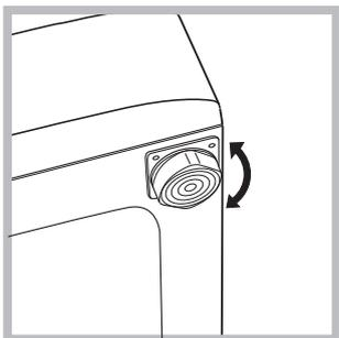
2. Sollte der Boden nicht perfekt eben sein, müssen die Unebenheiten durch An- bzw. Ausdrehen der vorderen Stellfüße ausgeglichen werden (siehe Abbildung), der auf der Arbeitsfläche zu ermittelnde Neigungsgrad darf  $2^\circ$  nicht überschreiten.
