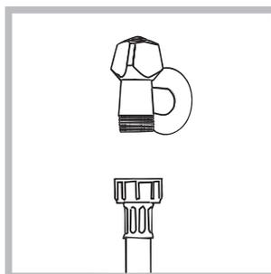
1. Dovodno cev za zrak priključite tako, da jo privijete na pipo za mrzlo vodo z vrezanim navojem 3/4" cola (glej sliko). Pred tem pustite teči vodo, da se izčisti.
