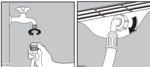
Le tuyau d'arrivée ne peut pas être prolongé. Si le tuyau est trop court, achetez un tuyau pour haute pression plus long, spécialement conçu pour lave-linge.
