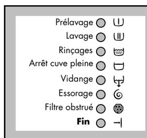
Le voyant Fin →| clignote lorsqu'il y a une anomalie dans le fonctionnement de la machine. En même temps un autre voyant et un code d'alarme clignotent signalant ainsi la nature de l'anomalie:
