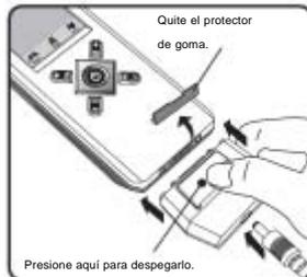
Para recargar las pilas, conecte el adaptador de corriente a una toma AC, introduzca el jack de DC en el conector y conéctelo a continuación a la toma situada en la parte inferior del mando a distancia. El tiempo máximo necesario para recargar las pilas es de 17 horas.
