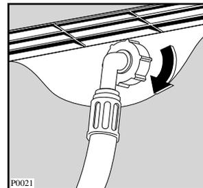
**B)** Si es necesario, oriente correctamente el tubo aflojando la tuerca del respaldo de la máquina
