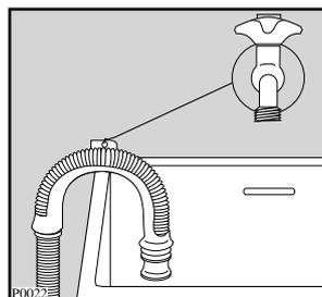
**D)** Sitúe la boca del tubo de descarga en el lavabo o pila con la ayuda de la pieza curva que se suministra aparte. La pieza curva se monta en la boca del tubo para facilitar su apoyo. Dicha pieza permite, mediante un orificio en su parte superior sujetarla a la pared para que el tubo no se desplace y evitar así posibles caídas de éste.
