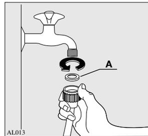
**A)** Introduzca en el extremo del tubo de carga la junta de goma (A) que se entrega con la máquina en la bolsita de plástico e inicie el roscado del tubo al grifo con cuidado, para no dañar la rosca y apriete bien la tuerca al final, para evitar pérdidas de agua.
